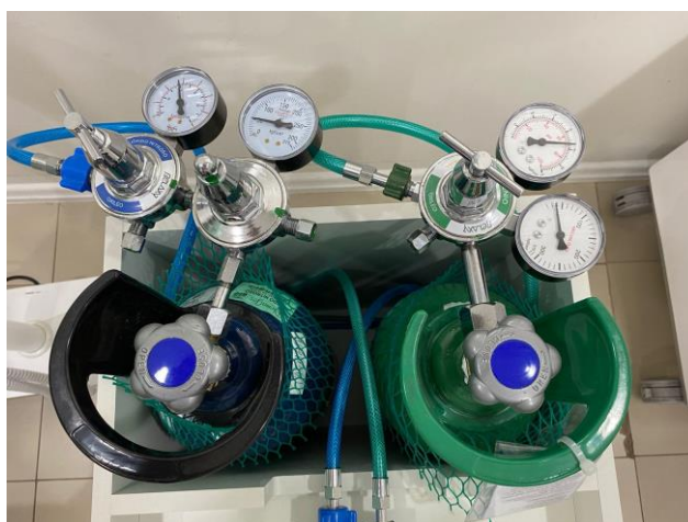
Figura 2. Aparelho de sedação consciente com N 2 O/O 2 calibrado.
